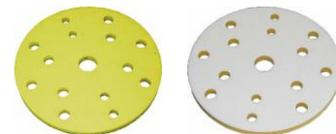
Verwenden Sie die harten Zwischenteller KX-971-0057 zum planschleifen der Oberflächen und für mehr Aggressivität. Der weiche Zwischenteller KX-971-0091 eignet sich zum Schleifen von runden Teilen und zum Verfeinern des Schliffbildes. Auch für MAGIC DISC Schleifscheiben geeignet.
