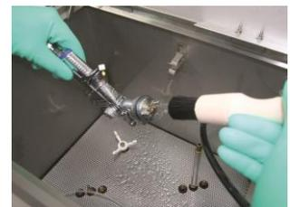
**Vorreinigung** mit dem Pinsel direkt über der Waschkammer mit Absaugung
